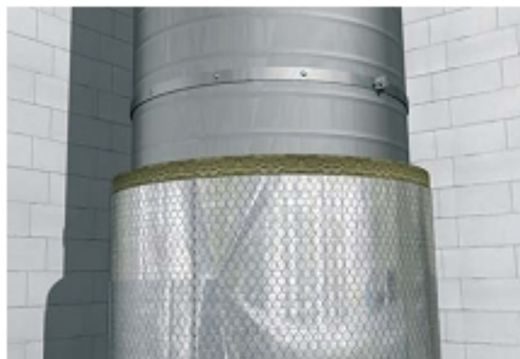
A szigetelőpaplan könnyen, kivágások nélkül beborítja a légszatórna illesztéseit és a tartókonzolokat.
