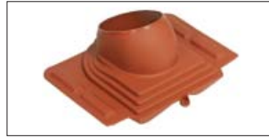
LTVTR trapézlemezhez LTP 20, 35, 45 trapézlemezekhez, LPA Scandic, Nordic cserepeslemezekhez Méret: 460 x 355 mm Tetőhajlás: 6-45° (csőtől függően)
