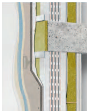
Födémre állított szerkezet perforált profilú vázzal
