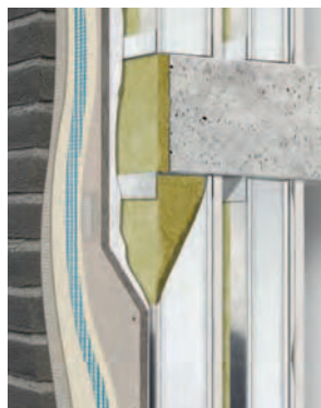
Kettős vázszerkezet impregnált gipszkarton köztes lemezzel
