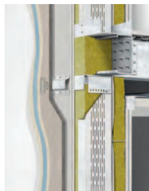
Kiszellőztetett homlokzat perforált profilú egyszeres vázzal
