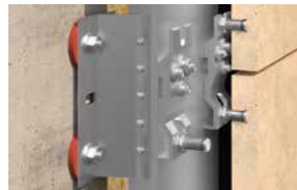
SystemOne Light homlokzati rendszer keresztmetszete terméskő esetén
