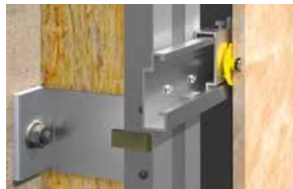
Homlokzat keresztmetszet kerámiához alkalmazható dübellel
